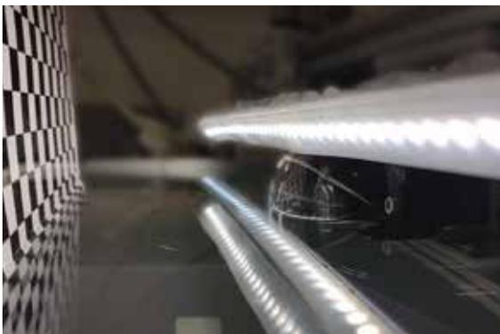
Kamera in einem halbkugelförmigen Gehäuse (Dome-Port) beobachtet ein Schachbrettmuster; halb unter Wasser, halb an Luft
