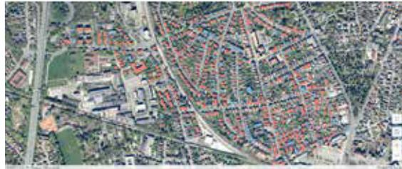
Abbildung 2: Ergebnis einer ML-Klassifikation (blau: geeignet; rot: ungeeignet) von KWEA-Potenzialgebäuden (eigene Darstellung; Hintergrundkarte: <https://www.arcgis.com/home/item.html?id=6cf42d6ad9e3480696c5021546e76fab>; © Esri, LGLN, Maxar, Microsoft; <https://www.esri.com/content/dam/esrisites/en-us/media/legal/ma-translations/german.pdf>)
