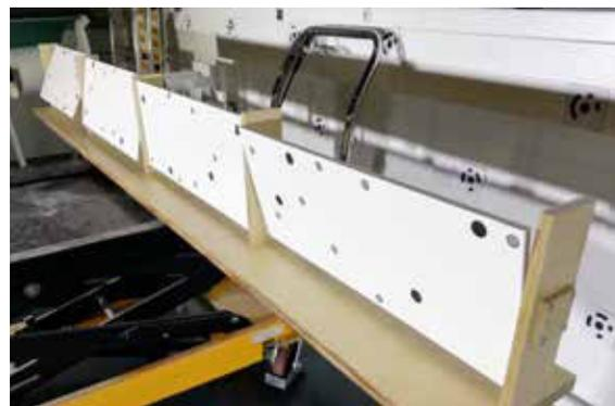
Abbildung 3: Torsionsobjekt auf Hubwagen mit photogrammetrischen Messmarken
