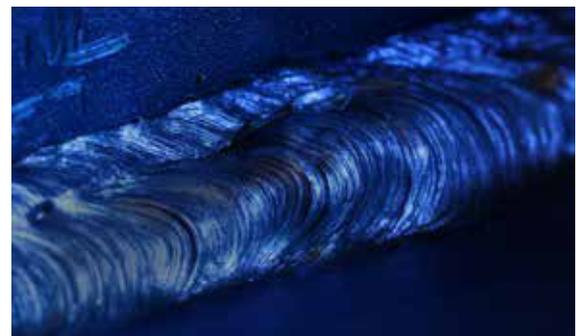
Detailansicht einer nassgeschweißten Kehlnaht
