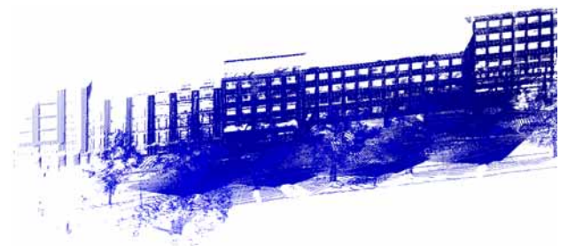
Beispiel für eine bei einer Fassadenaufnahme von einem Laserscanner produzierte Punktwolke
