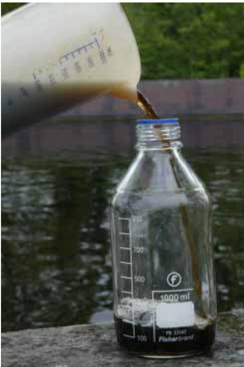
Probennahme von Deponiesickerwasser für die chemische Analytik
