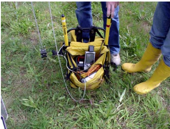
Outdooreinsatz auf einem Testfeld zur Reflexionsmessung an einer Pflanze
