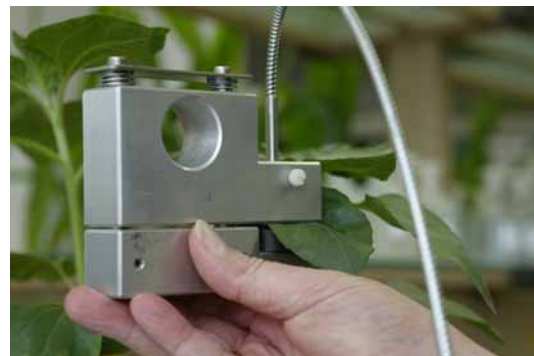
Messzange zur hyperspektralen Messung von Pflanzen mit definierten Randparametern
