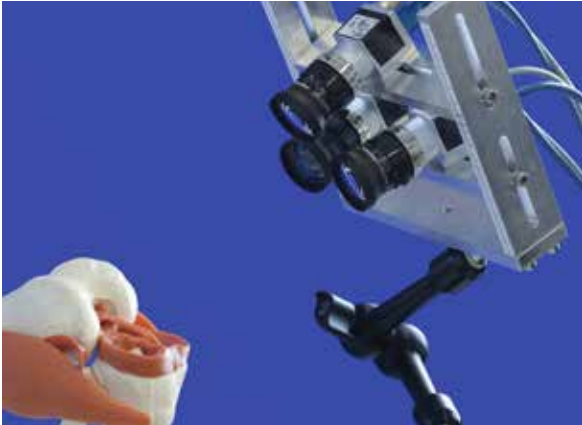
Dreikamerasystem mit variabler Halterung bei einer Testaufnahme mit einem künstlichen Kniegelenkmodell
