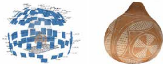
Abb. 1: 3D-Erfassung und Rekonstruktion einer Kalebasse aus Sumatra (Landesmuseum Natur und Mensch Oldenburg) links: Bildverband des SfM in Agisoft; rechts: 3D-Modell mittels SfM
