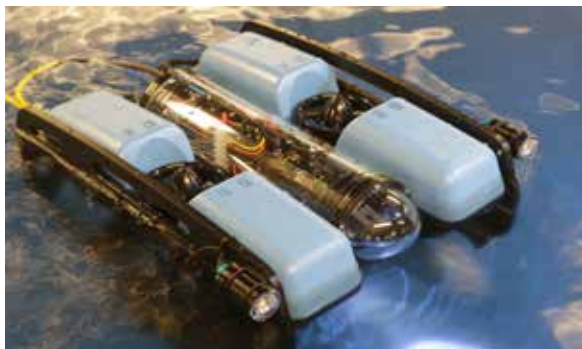
Abb. 1: Die gewählte Trägerplattform BlueROV2
