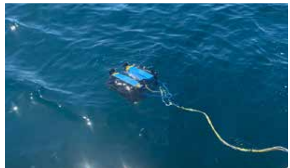
Unbemanntes Unterwasserfahrzeug (ROV) mit dem entwickelten Multisensorsystem an Land (oben) und im Wasser (unten)
