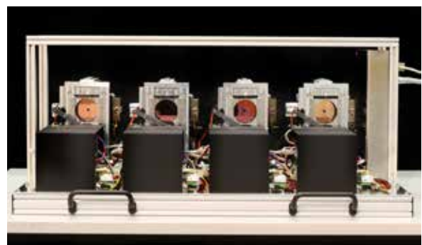
Abb. 1: Neu entwickeltes fächerartiges Distanzmesssystem, bestehend aus 4 Distanzmessern des Laserscanners Z+F Imager 5006
