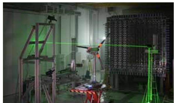
Abb. 1: Messaufbau für eine PIV-Messung im Windkanal der Universität Oldenburg (Kröger, AG TWiSt, ForWind, Universität Oldenburg)
