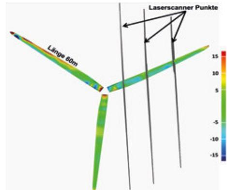
Vergleich zwischen berechneter Verformung und Sollgeometrie
