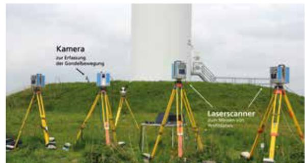
Messaufbau mit vier Laserscannern und einer Kamera an einer Windenergieanlage
