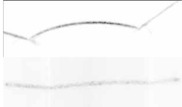
Abb. 4: Vergleich Messbilder (Negativ der Rohdaten): abgebildete Laserlinie eines Laserlichtschnittsensors (oben) und eines Stereokamerasystems mit projizierender Infrarot-Laserlinie (unten)
