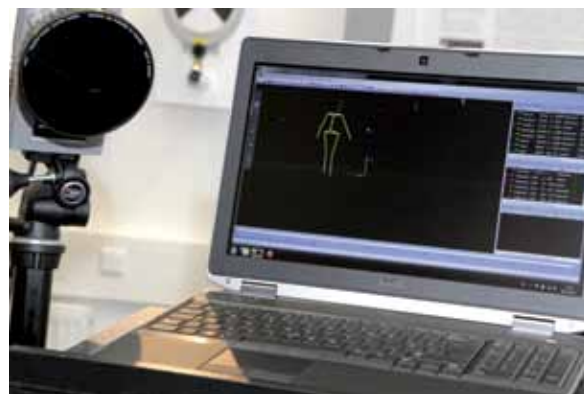
Abb. 2: Eine beobachtete Bewegung wird dreidimensional wiedergegeben und kann anschließend ausgewertet werden.
