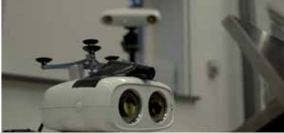
Abb. 3: Scannen eines Referenzkörpers: Stereosystem Cam-Bar B1 der Firma Axios 3D mit fixiertem Lokator und Laserlinienmodul wird von einer CamBar B2 (im Hintergrund) getrackt
