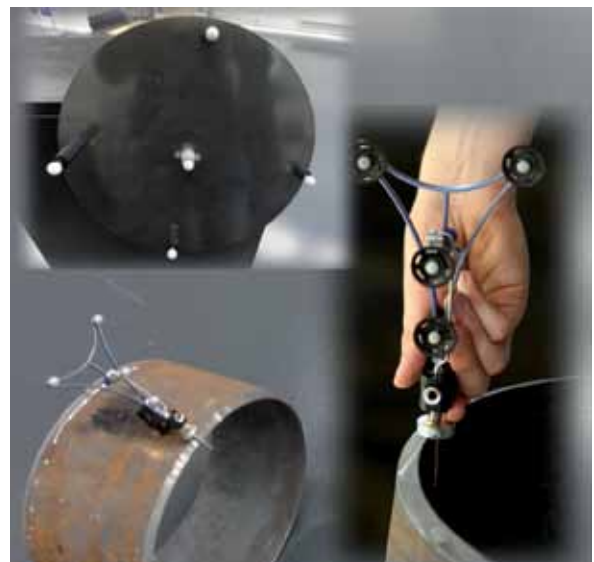
Handgeführter Lokator zur Antastung einer Rohrkante, oben die Referenzscheibe
