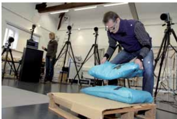
Abb. 1: Im Labor untersuchte reale Arbeitstätigkeit wie sie in einem Lager zu finden ist: Säcke von 20kg Gewicht werden zwischen zwei Paletten hin- und hertransportiert.
