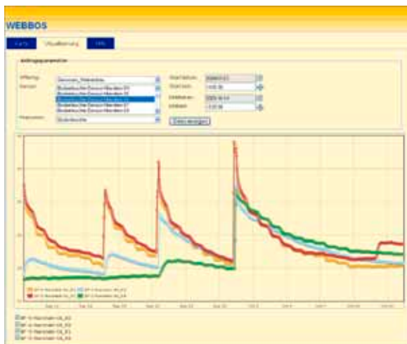
Graphische Darstellung von Messwerten einer Bodenfeuchteprofilmessung
