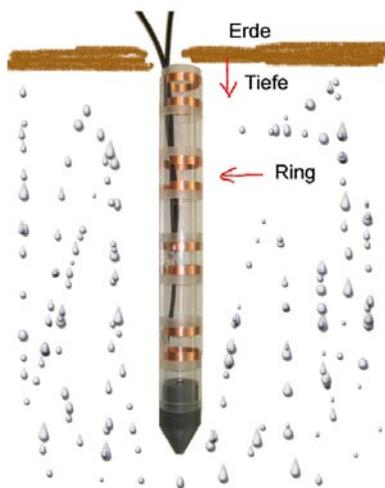
Beispielsensor für die Bodenfeuchteprofilmessung (jeder Ring liefert Messwerte)
