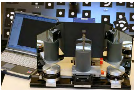
Optischer Stereovorsatz als Laboraufbau
