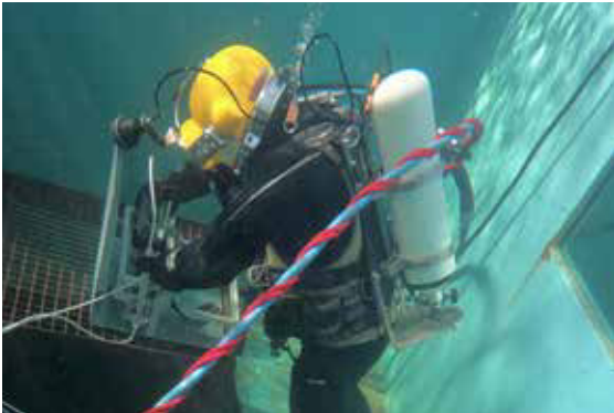
Schweißfachingenieur im Tauchcontainer. Der Taucher nimmt mit Hilfe des Prototypen des IAPG hochaufgelöste Bilddaten einer Schweißnaht auf.
