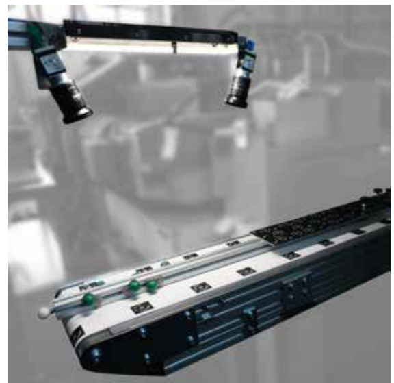
Abb. 1: Stereokamerasystem zum Tracking der Bewegung des Förderbandes
