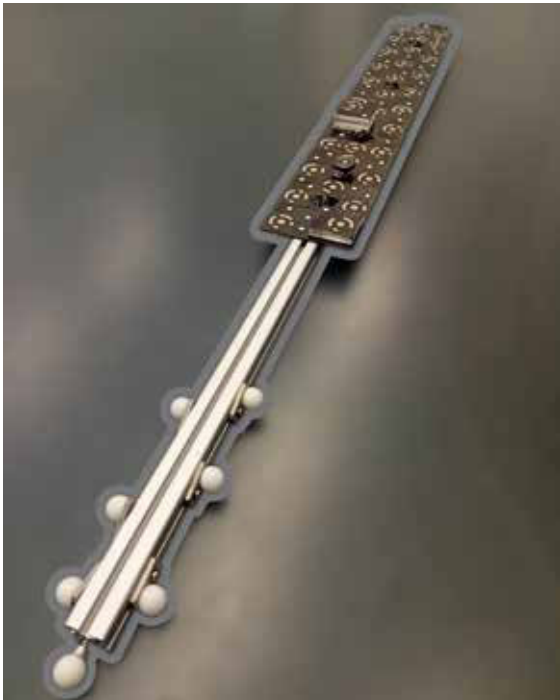
Abb. 2: Entwickelter Kalibrierkörper zur Orientierung zwischen LS und Kamerasystem
