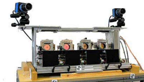
Abbildung 1: Das fächerartige Distanzmesssystem besteht aus vier Distanzmessern sowie zwei Kameras
