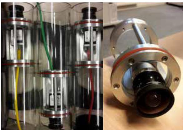
Abb. 3: Dreikamerasystem in den Druckgehäusen eingefasst (links) und Halterung zur Arretierung innerhalb der Druckgehäuse (rechts)
