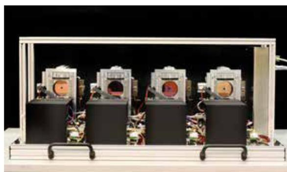
Neu entwickeltes fächerartiges Distanzmesssystem, bestehend aus 4 Distanzmessern vom Z+F Imager 5006
