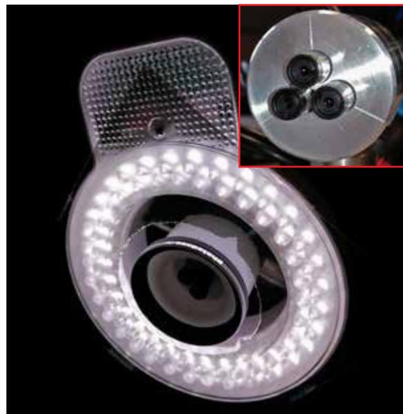
Prototypischer Kamerakopf mit drei miniaturisierten Kameras, Ringlicht und kreuzweise angeordneten Polarisationsfiltern
