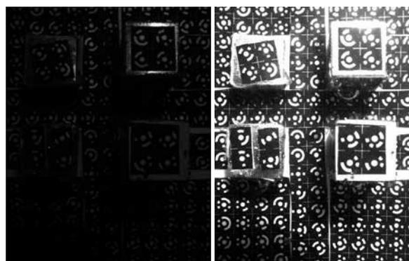
Abb. 2: links: Aufgenommenes Testfeld im trüben Wasser rechts: Modifiziertes Bild. Nach der Histogrammspreizung des Originalbildes steigt die Anzahl der messbaren Marken.
