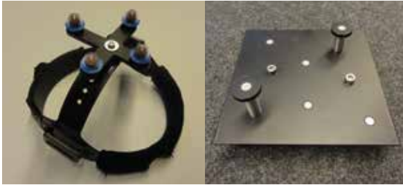
Abb. 2: Punktgruppe, die mit Hilfe eines Gestells am Kopf befestigt wird (links) und Referenzfeld für die Festlegung des Koordinatensystems und Kompensation möglicher Kamerabewegungen (rechts)
