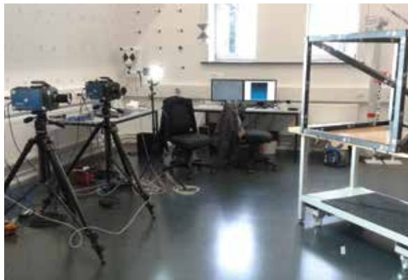
Kamerakonfiguration mit einem Testkörper nach VDI 2634.1
