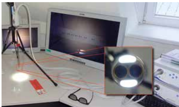
Stereo-Endoskop EinsteinVision mit Lichtquelle, 2D- und 3D-Monitor / Roter Bildausschnitt zeigt Endoskopspitze
