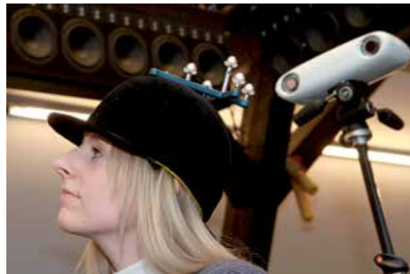
Abb. 1: Darstellung des Versuchsaufbaus: Eine Probandin hört Schallereignisse, die von einer Wellenfeldsynthese erzeugt/abgespielt werden (Hintergrund). Währenddessen wird mit Hilfe eines Trackingsystems beobachtet, ob die Probandin Kopfbewegungen nutzt, um die Schallquelle besser orten zu können.
