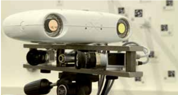
Abb. 3: Aktueller Messkopf; oberes Stereokamerasystem (AXIOS 3D Services GmbH) dient der Navigation, unteres Stereokamerasystem (Basler AG) sowie Laserlinienmodul dient der Oberflächenerfassung
