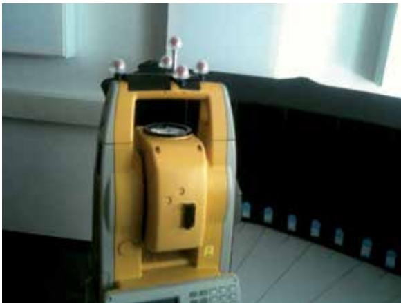
Abb.4: Genauigkeitsuntersuchung mit Tachymeter-Referenzmessung
