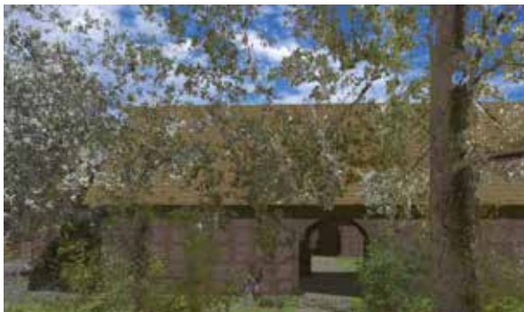
Abb. 1: Vektormodell eines Museumsgebäudes mit RGB-gefärbter Laserscanning-Punktwolke (Bentley Microstation)
