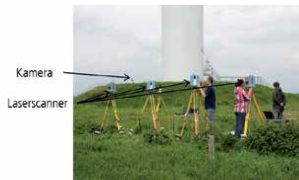
Messaufbau an einer Windenergieanlage
