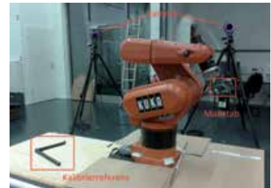
Versuchsaufbau zur Kalibrierung des Systems
