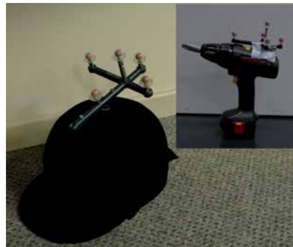
Abb.2: Kopfbedeckung mit Lokator (großes Bild), kindgerechtes Zeigeinstrument mit aufgesetztem Lokator (kleines Bild)
