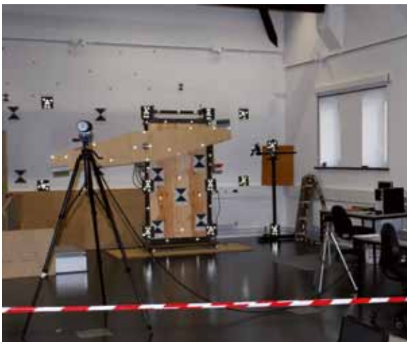
Kombinierte Aufnahme eines Laboraufbaus mit einem Laser-scanner und einem optischen Messsystem
