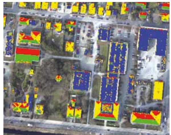
FH-Campus: Ausrichtung und Neigung der Dachflächen
