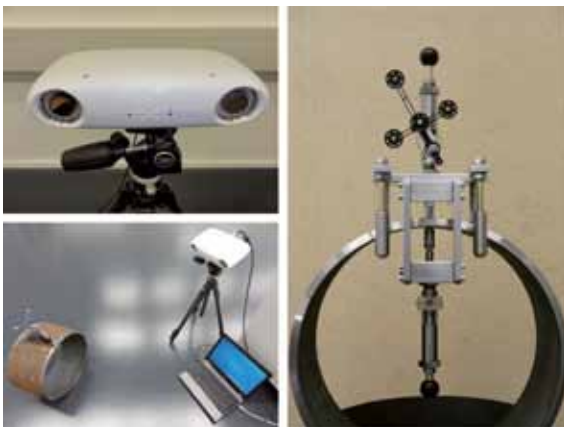
Stereokamera und Messadapter zur Erfassung der Rundheit
