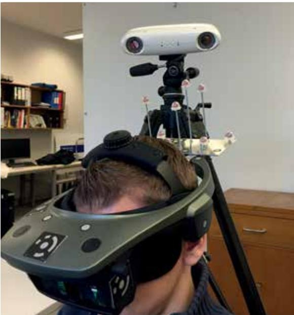
Abb. 1: Darstellung des Augmented-Reality-Systems. Das HMD projiziert ein virtuelles Modell über Spiegel auf die Optik. Ein Optical See-Through HMD ermöglicht das Durchsehen durch die Optik. Dadurch kann die virtuelle mit der realen Welt überlagert werden. Die Stereokamera ist für die Positions- und Richtungsbestimmung des HMDs nötig
