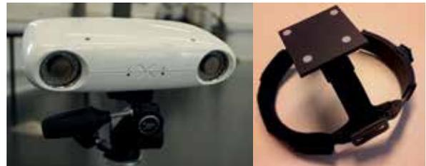
Abb. 2: Verwendete Kamera CamBar B2 (links) und Gestell zur Befestigung eines Punktfeldes am Kopf der Probanden (rechts)
