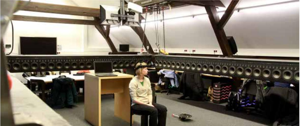
Abb. 4: Kontrollierte Versuchsumgebung im Labor für virtuelle Welten: Lautsprecher der Wellenfeldsynthese auf Ohrhöhe, Referenz am Boden und Kamera oberhalb des Probandenkopfes
