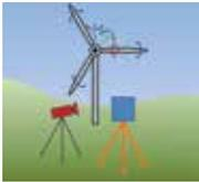
**Ziel dieses Promotionsvorhabens ist die Weiterentwicklung berührungsloser 3D-Messverfahren zur Erfassung von Oberflächendaten im laufenden Betrieb einer Windenergieanlage (WEA) und die darauf aufbauende Modellierung von Rotorblattgeometrien auf Basis von zeitabhängigen 3D-Messdaten.**
