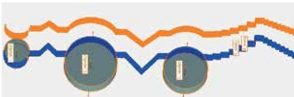
Abb. 4: Ergebnispunktswolke einer navigierten Unterwassermessung und Berechnung von Merkmalen (Zylinder, Ebenen); orange: ohne Brechungskorrektur; blau: mit Brechungskorrektur
