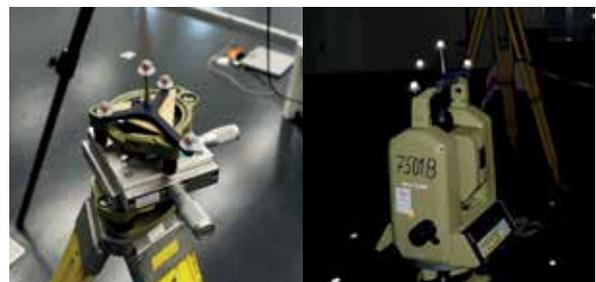
Abb. 3: Versuchsaufbauten zur Überprüfung der Genauigkeit der Positions- (links) und Rotationsbestimmung (rechts)
