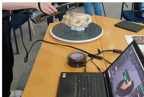
Aufbau der Scanszene mit dem Creiform Go!Scan Spark Handscanner
