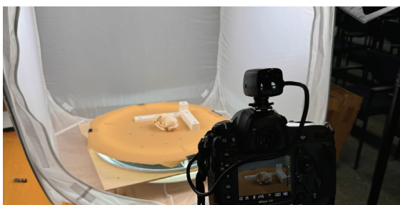
Aufbau der photogrammetrischen Erfassung im Lichtzelt mit Drehteller
