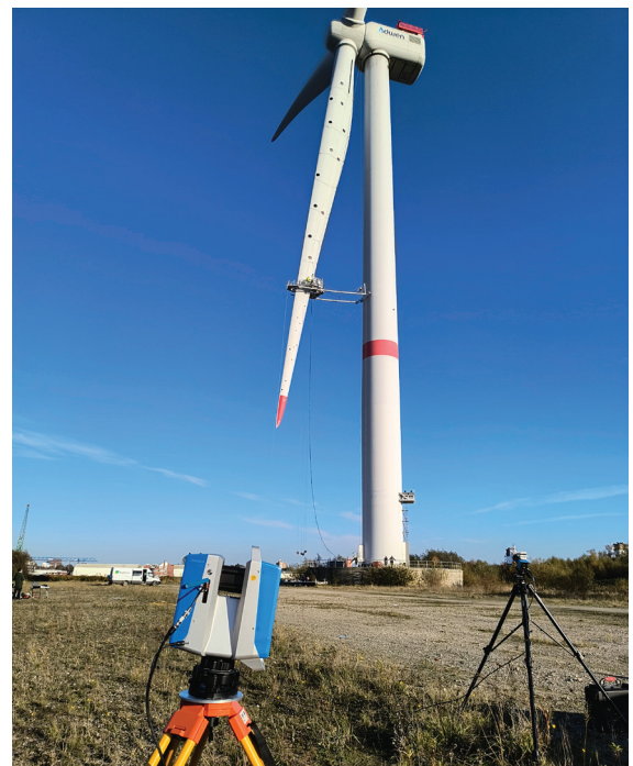
Abb. 1: Laserscanner an einer Windenergieanlage zur Erfassung von Profildaten entlang der Blattlängsachse
