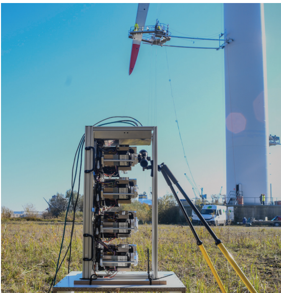
Abb. 2: Einsatz des Fächersensors zur Erfassung punktueller Schwingungen am Rotorblatt
